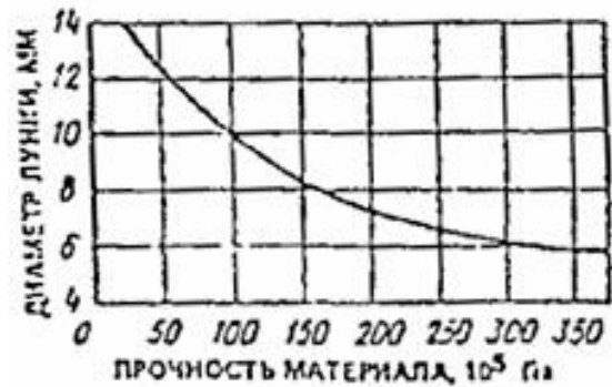
Рисунок 7.2.- Тарировочный график для определения предела прочности бетона при сжатии молотком Физделя
